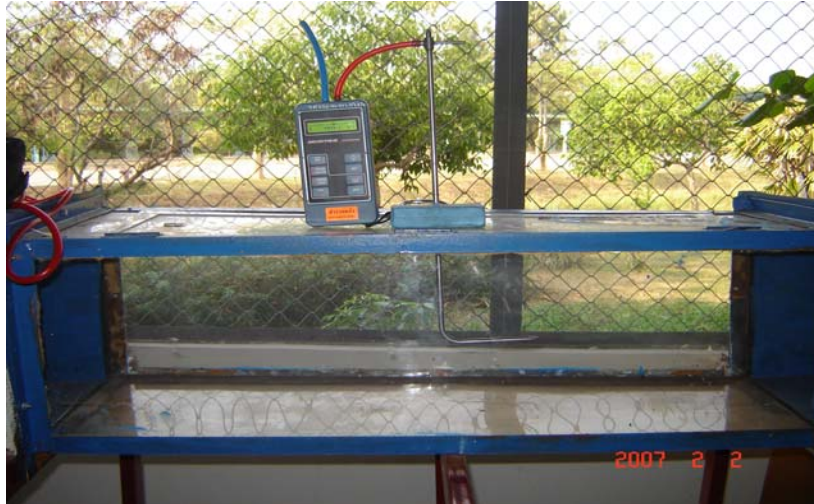
รูปที่ 5.7 การวัดความเร็วลมภายในห้องทดสอบที่ตำแหน่งทดสอบ
