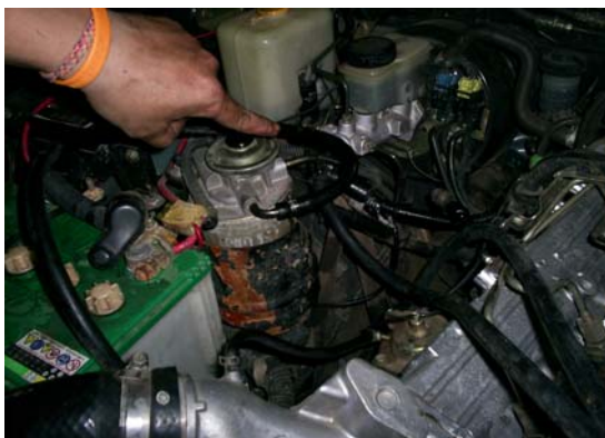
รูปที่ 5.2 แสดงถึงการต่อสายจากถังน้ำมันดัดแปลงเข้าปั๊มไล่อากาศ
