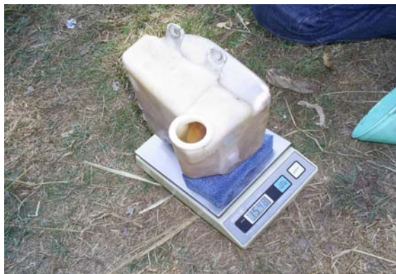
รูปที่ 5.3 แสดงถึงการชั่งน้ำหนักน้ำมันเชื้อเพลิงหลังการทดสอบ
