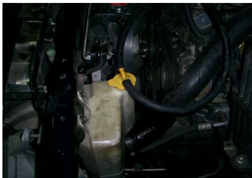
รูปที่ 5.1 แสดงถึงการติดตั้งถังน้ำมันที่ดัดแปลง
