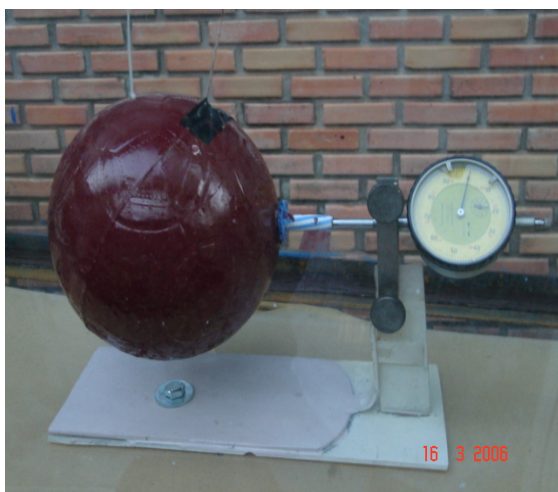
รูปที่ 5.6 การติดตั้งแบบจำลองเข้ากับเครื่องมือวัดแรง
