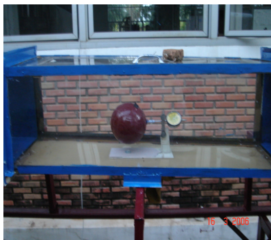
รูปที่ 5.6 การติดตั้งแบบจำลองเข้ากับเครื่องมือวัดแรง
