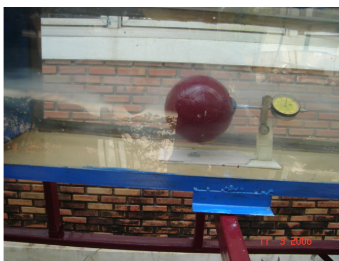
รูปที่ 5.5 การทดสอบ Smoke Test
