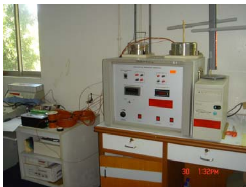
รูปที่ 5.1ค ภาพแสดงการทำารปรับเทียบเครื่องมือวัดเทอร์โมคัปเปิลสายอ่อน
