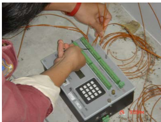
รูปที่ 5.1ก ภาพแสดงเครื่องมือวัด Data Logger และการติดตั้งเข้ากับสายเทอร์โมคัปเปิลอ่อน
