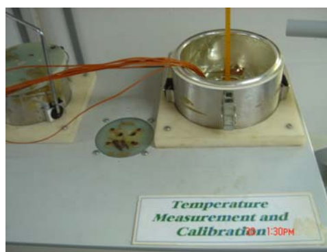
รูปที่ 5.1ค ภาพแสดงการทำารปรับเทียบเครื่องมือวัดเทอร์โมคัปเปิลสายอ่อน
