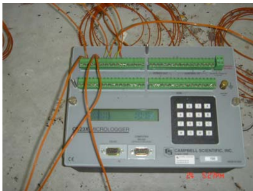
รูปที่ 5.1ก ภาพแสดงเครื่องมือวัด Data Logger และการติดตั้งเข้ากับสายเทอร์โมคัปเปิลอ่อน
