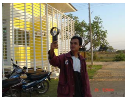
รูปที่ 5.3 ภาพแสดงเครื่องมือวัด Anemometer และภาพแสดงการตรวจวัดด้วย Anemometer
