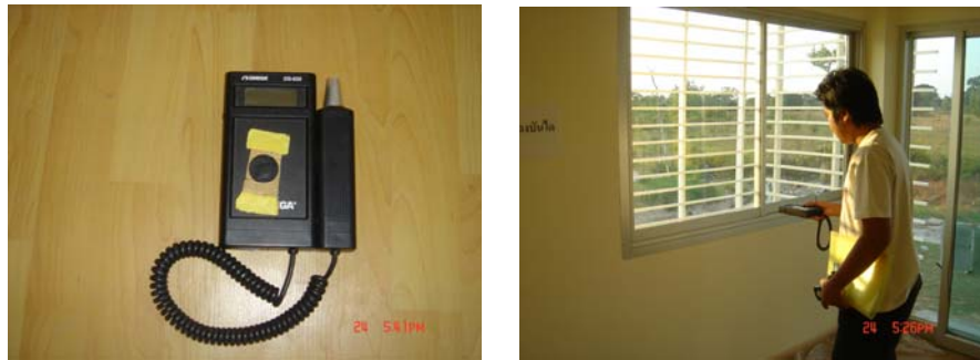
รูปที่ 5.5.ภาพแสดงเครื่องมือวัด Heatgriantmeter และภาพแสดงการตรวจวัด Heatgriant
