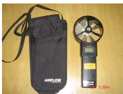
รูปที่ 5.3 ภาพแสดงเครื่องมือวัด Anemometer และภาพแสดงการตรวจวัดด้วย Anemometer
