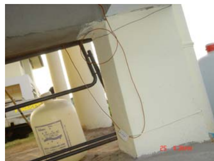
ต่อสายเทอร์โมคัปเปิลออกมาที่กลางแจ้ง และในร่มเพื่อวัดอุณหภูมิภายนอก
