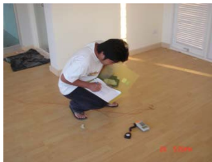
รูปที่ 5.4.ภาพแสดงเครื่องมือวัด Luxmeter และภาพแสดงการตรวจวัดความส่องสว่างด้วย Luxmeter
