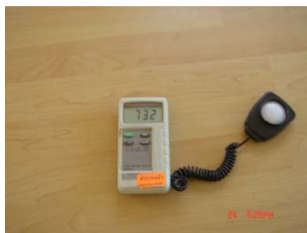
รูปที่ 5.4.ภาพแสดงเครื่องมือวัด Luxmeter และภาพแสดงการตรวจวัดความส่องสว่างด้วย Luxmeter
