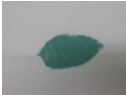
รูปที่ 4.6 ลักษณะสารประกอบคอปเปอร์ออกไซด์ที่สังเคราะห์ได้โดยใช้เปลือกไข่ไก่อบและสารละลายคอปเปอร์ซัลเฟต
