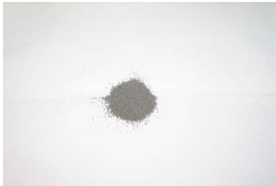
รูปที่ 4.3 ลักษณะของเปลือกไข่ไก่เผาที่อุณหภูมิ 550 องศาเซลเซียส เป็นเวลา 25 นาที ขนาด 20-40 เมช
