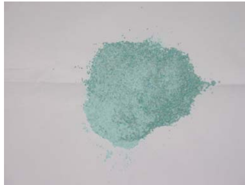
รูปที่ 4.8 ลักษณะของสารประกอบคอปเปอร์ออกไซด์ที่สังเคราะห์ได้โดยใช้เปลือกไข่ไก่เผาและสารละลายคอปเปอร์ซัลเฟต
