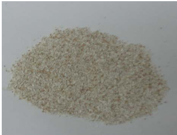
รูปที่ 4.1 ลักษณะของเปลือกไข่ไก่อบที่อุณหภูมิ 105 องศาเซลเซียส เป็นเวลา 4 ชั่วโมง ขนาด 20-40 เมช
