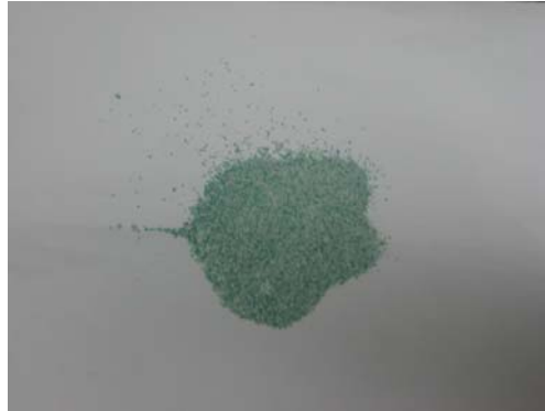
รูปที่ 4.10 ลักษณะของสารประกอบคอปเปอร์ออกไซด์ที่สังเคราะห์ได้โดยใช้เปลือกไข่ไก่อบและน้ำเสียนคอปเปอร์ซัลเฟตเข้มข้น
