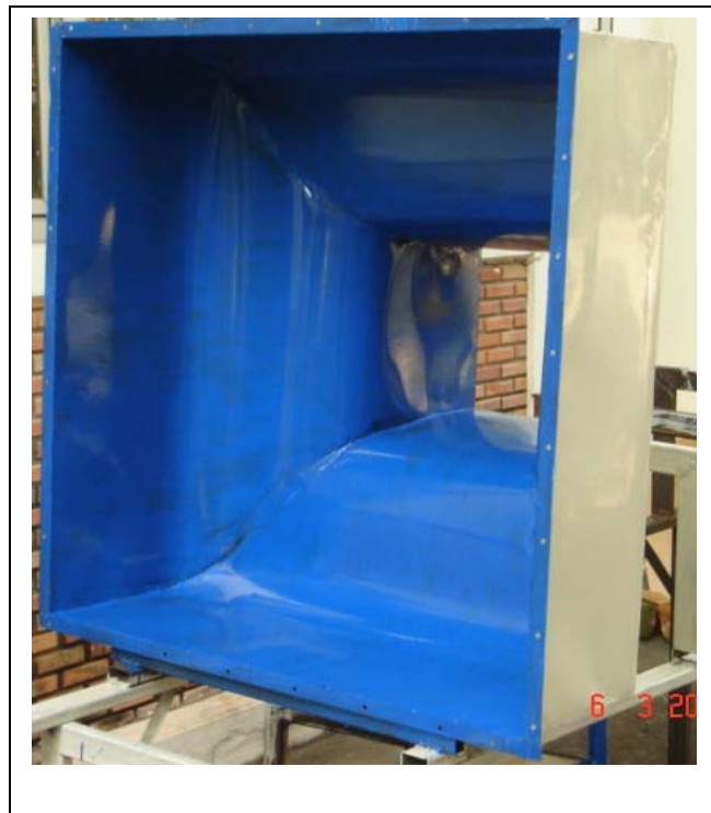
รูปที่ 4.1 ภาพก่อนการติดตั้งรังผึ้ง
