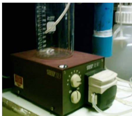
(ข) แสดงปั๊ม Peristaltic ที่ใช้ในการทดลอง
