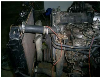
รูปที่ 4.6 แสดงการติดตั้งท่อวัดอุณหภูมิน้ำหล่อเย็น
