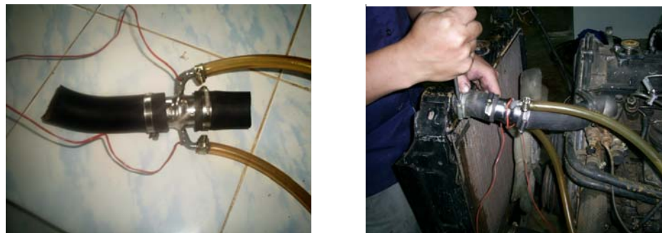
รูปที่ 4.4 แสดงการต่อสายน้ำมันเข้าอุปกรณ์ประหยัดน้ำมันและการติดตั้งเข้ากับเครื่องยนต์
