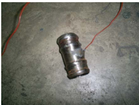
รูปที่ 4.2 แสดงการเตรียมท่อต่อเพื่อวัดอุณหภูมิน้ำหล่อเย็น
