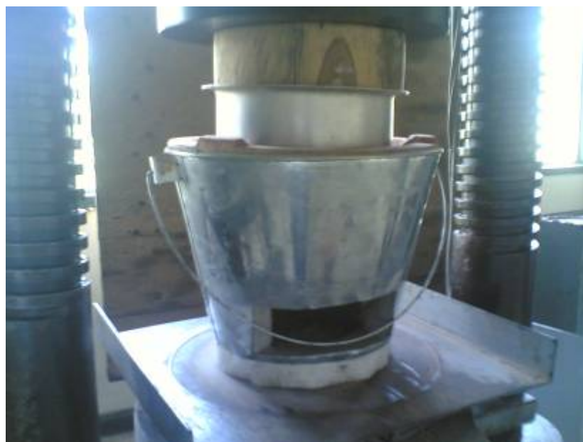
รูปที่ 4.9 แสดงการกดเตาอบบลูที่มีรูปร่างแบบเดิมและใส่ถังสังกะสีด้วยเครื่อง Tokyo
