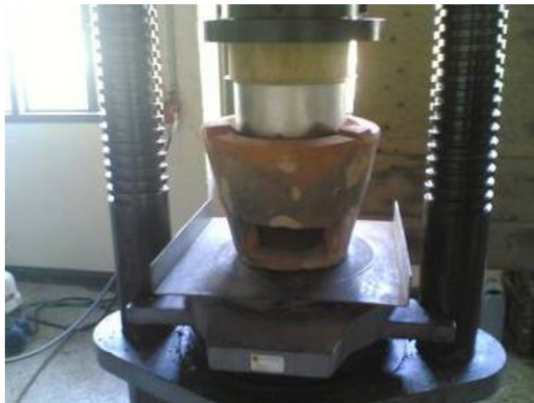
รูปที่ 4.7 แสดงการกดเตาอบลฯเมื่อทำการเปลี่ยนรูปร่างและไม่ใส่ถังสังกะสีด้วยเครื่อง Tokyo Testing Machine
