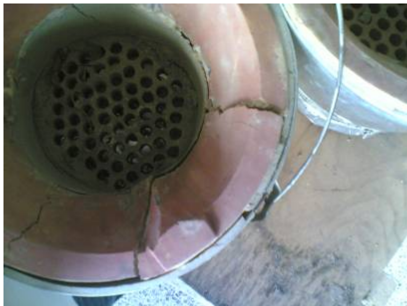
รูปที่ 4.10 แสดงสภาพเตาอบฯที่มีรูปร่างแบบเดิมและใส่ถั่งสังกะสีหลังกดด้วยเครื่อง Tokyo Testing Machine
