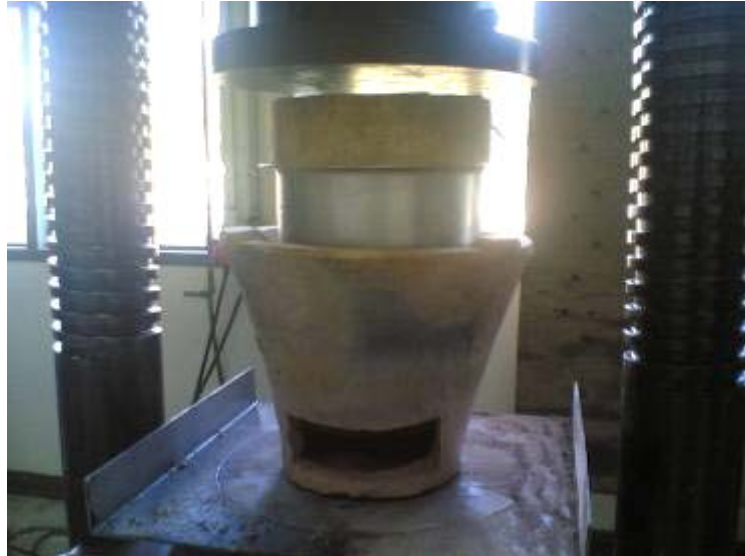
รูปที่ 4.4 แสดงการกดเตารูปรางเดิมและไม่ใส่ถังสังกะสีด้วยเครื่อง Tokyo Testing Machine
