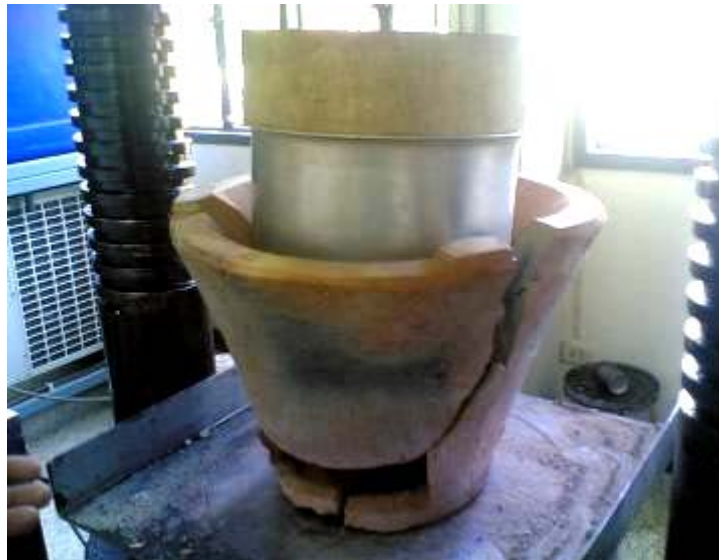
รูปที่ 4.5 แสดงสภาพเตารูปรางเดิมและไม่ใส่ถังสังกะสีหลังกดด้วยเครื่อง Tokyo Testing Machine
