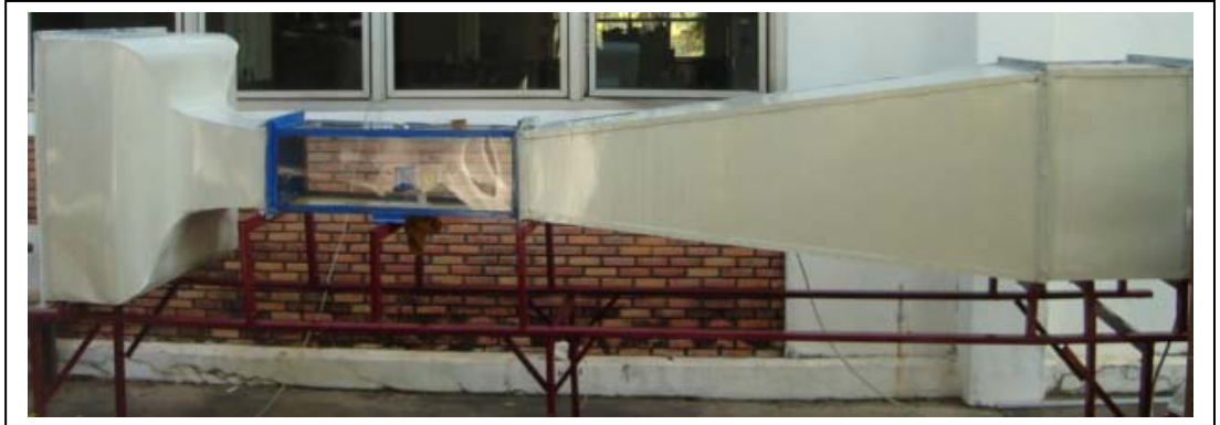
รูปที่4.19 อุโมงค์ลมที่สร้างขึ้นเสร็จสมบูรณ์
