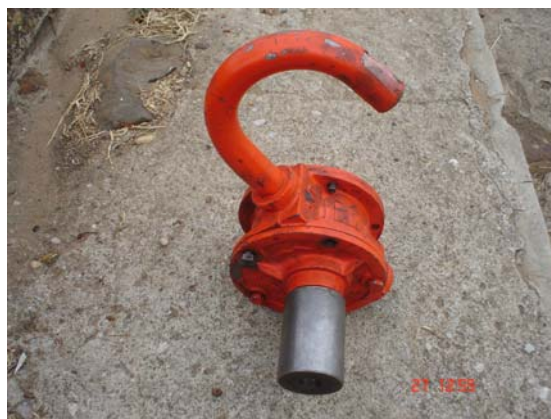
รูปที่ 4.4 ภาพปั๊มมือหมุน ( Vane ปั๊ม)
