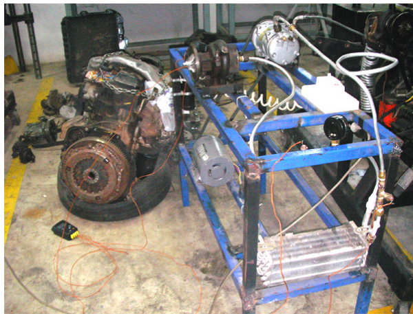
รูปที่ 4.3 การต่อเทอร์โมคอปเปิล
