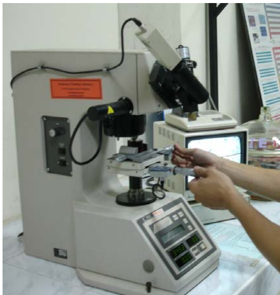
รูปที่ 4.9 แสดงเครื่องวัดความแข็งชนิด Micro Hardness Test ของ Multitoyo
