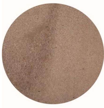
รูปที่ 4.13 แสดงภาพบริเวณรอยเชื่อมที่กำลังขยาย 50 เท่า
