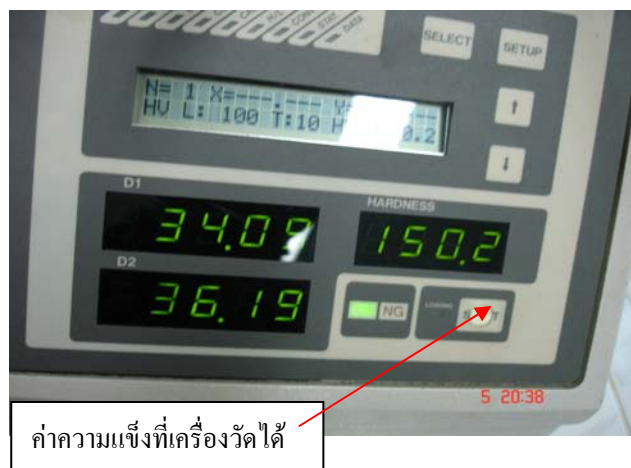
รูปที่ 4.12 แสดงตัวอย่างของการอ่านค่าความแข็งจากเครื่อง Micro Hardness
