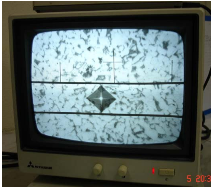
รูปที่ 4.11 แสดงการวัดเส้นทแยงมุมในแนวตั้งของรอยกดจากเครื่อง Micro Hardness
