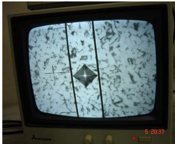
รูปที่ 4.10 แสดงการวัดเส้นทแยงมุมในแนวราบของรอยกดจากเครื่อง Micro Hardness
