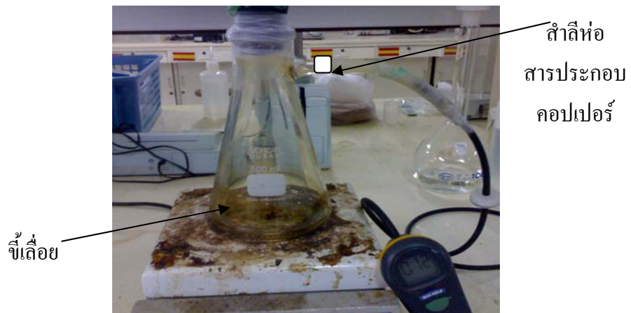
รูปที่ 3.3 ชุดการทดลองหาความเข้มข้นของก๊าซคาร์บอนมอนอกไซด์โดยไม่ได้เผาเชื้อเพลิงร่วมกับสารประกอบคอปเปอร์ออกไซด์
