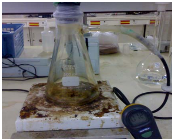
รูปที่ 3.2 ชุดทดลองเพื่อหาความเข้มข้นของก๊าซคาร์บอนมอนนอกไซด์โดยการเผาซีลี้อยู่ร่วมกับสารประกอบคอปเปอร์ออกไซด์ที่สังเคราะห์ได้
