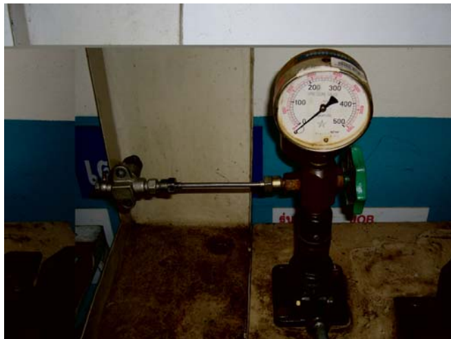
รูปที่ 3.8 แสดงการต่อเครื่องทดสอบแรงดันชุดหัวฉีด
