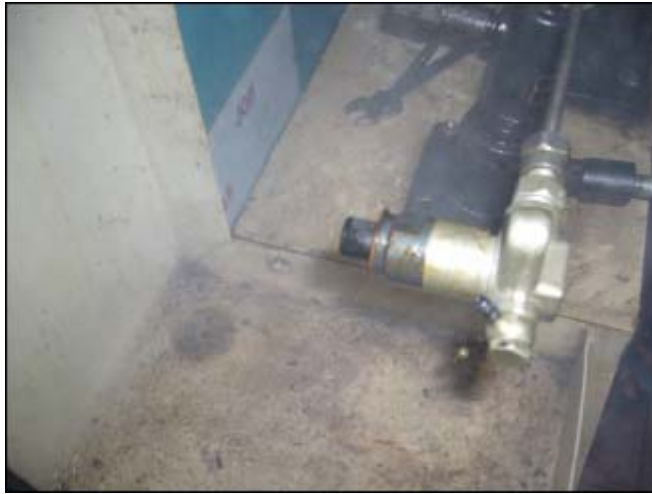
รูปที่ 3.9 แสดงละอองน้ำมันที่ออกจากหัวฉีดขณะอ่านค่าจากเกจวัดความดัน
