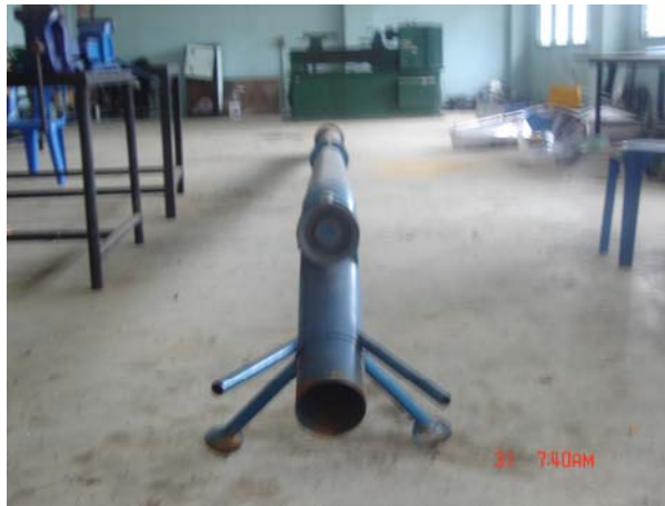
รูปที่ 3.1 ท่อสูบน้ำที่ใช้เป็นภาระกับเครื่องยนต์
