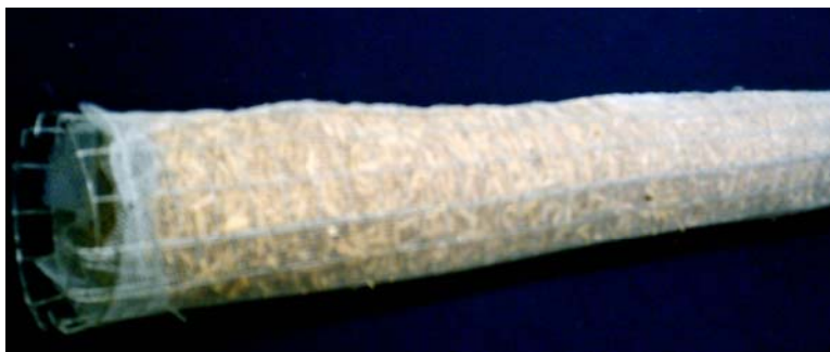
ภาพที่ 3.2 แสดงการยึดตรึงแกลบไว้ในถังหมัก โดยการบรรจุใส่ในหลอดตาข่าย
