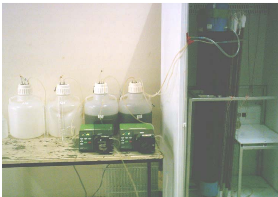
ภาพที่ 3.19แสดงกระบวนการหมักในต้นแบบถังหมักที่ 2 (ท่อไอ) ครั้งที่ 1
