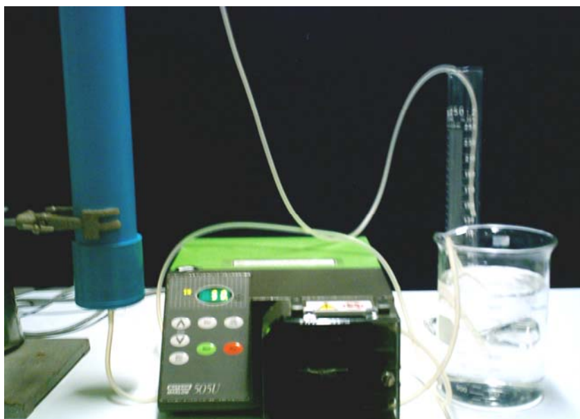
ภาพที่ 3.11 แสดงการทดลองหาอัตราการไหลเข้าเทียบอัตราการไหลออกของน้ำหมัก
