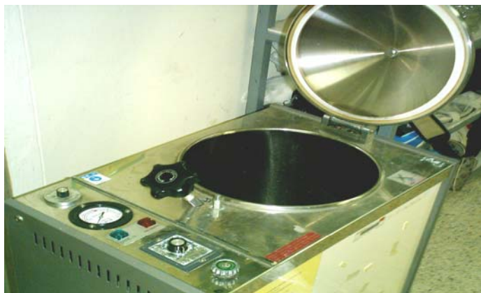
ภาพที่ 3.5 แสดงเครื่อง Autoclave ที่ใช้ในกระบวนการทำให้ปลอดเชื้อ
