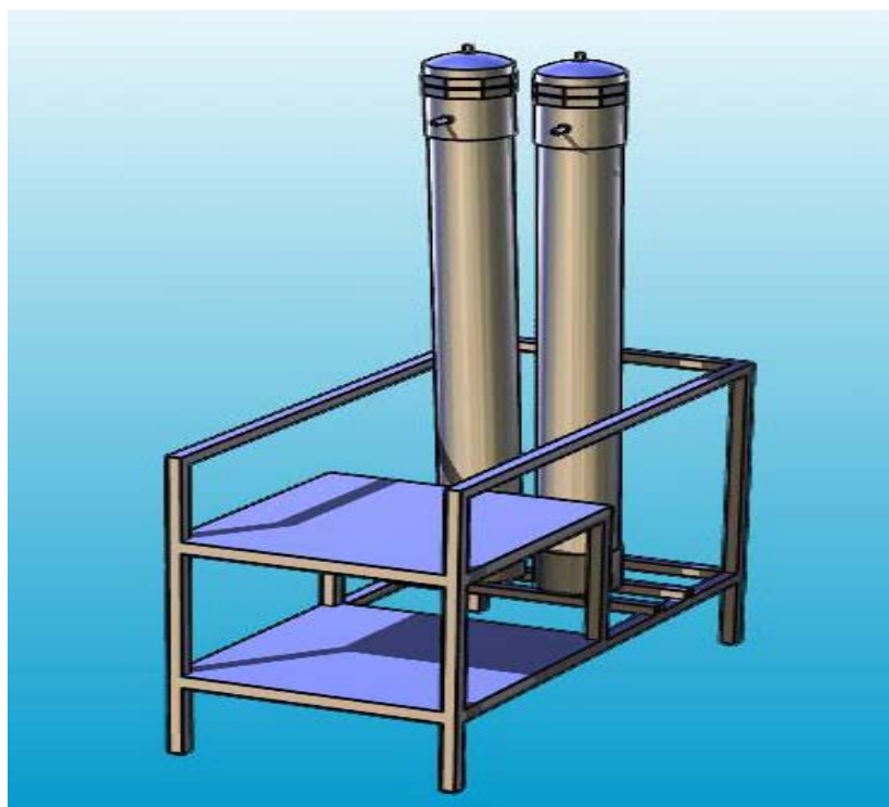
ภาพที่ 3.16 แสดงแบบของต้นแบบถังหมักที่ 2
