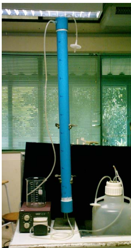
ภาพที่ 3.15 แสดงการทดลองกระบวนการหมักในต้นแบบถังหมักที่ 1 (ท่อPVC)
