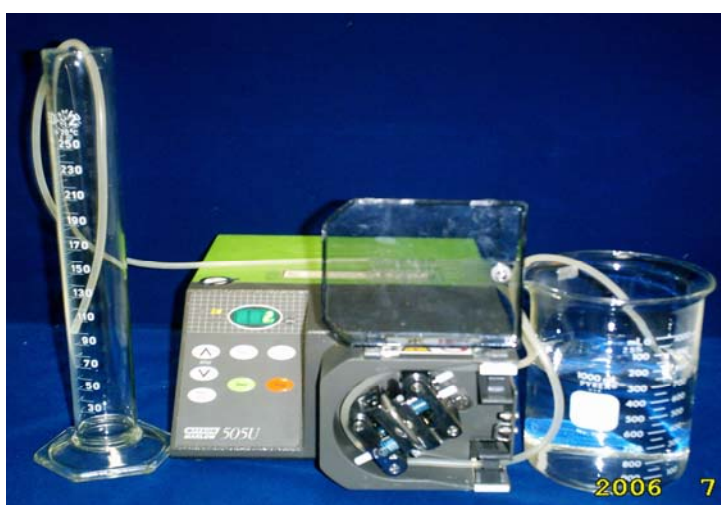
ภาพที่ 3.8 แสดงการทดลองหาคุณสมบัติการทำงานของปั๊ม
