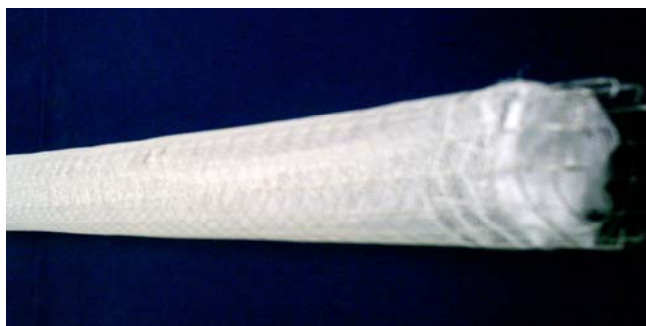
ภาพที่ 3.13 แสดงรูปหลอดตาข่ายที่ใช้ผ้าตาข่ายพลาสติกเย็บล้อมอีกที
