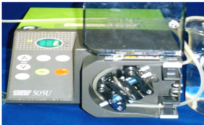
ภาพที่ 3.4 แสดงป้อน Peristaltic อาศัยหลักการบีบทับของของเหลวในสายยางให้เกิดการไหล
