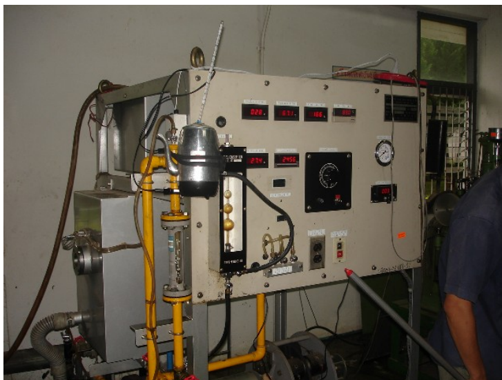
รูปที่ 3.3 แสดงเครื่องทดสอบ Diesel Research And Test Bed(DERTB)
