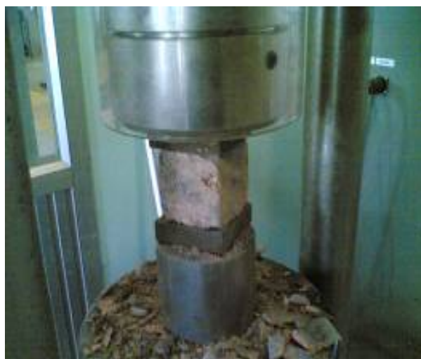
รูปที่ 3.11 แสดงการทดสอบการรับแรงกดสูงสุดก่อนพังของชิ้นทดสอบ
