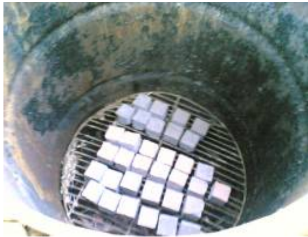
รูปที่ 3.10 แสดงการนำชิ้นทดสอบเข้าเตาเผา
