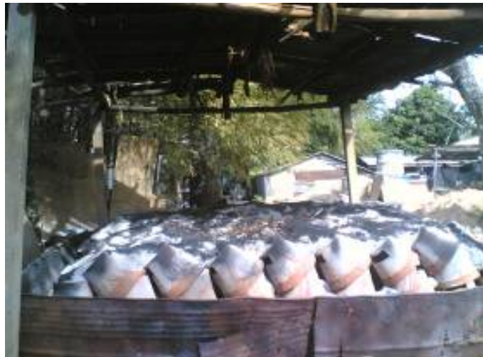
รูปที่ 3.3 แสดงเตาเผาแบบเปิดโดยใช้เกลบ
