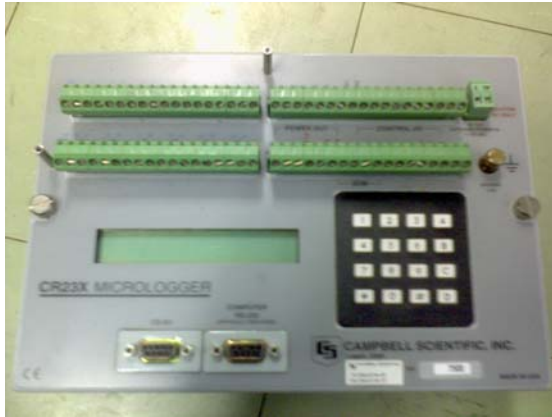
รูปที่ 3.8 ลักษณะตัวเครื่องมือวัดและบันทึกอุณหภูมิ CR23 Micrologger
