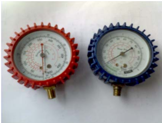
รูปที่ 3.9 ลักษณะเกจวัดความดันทางด้าน High Pressure และ Low Pressure
