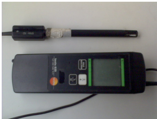
รูปที่ 3.11 ลักษณะของเครื่องมือวัดความชื้นสัมพัทธ์ของอากาศ
