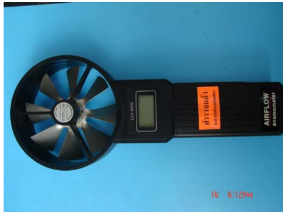
รูปที่ 3.10 ลักษณะ Air Flow anemometer รุ่น LCA 6000
