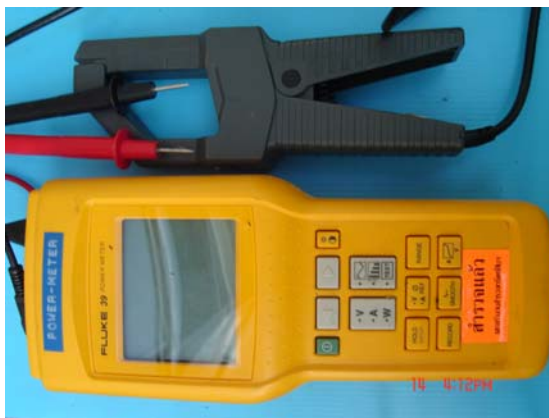
รูปที่ 3.7 ลักษณะตัวเครื่อง Power Meter Fluke 39
