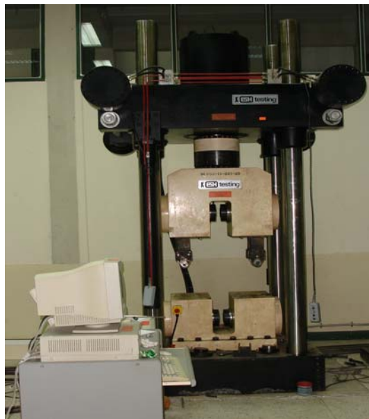
รูปที่ 3.1 เครื่องทดสอบ Universal Testing Machine
