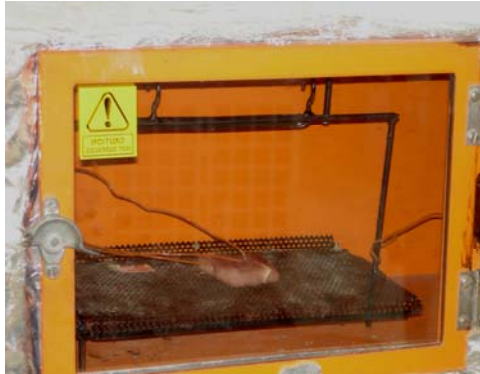
รูปที่ 3.10 นำเนื้อเข้าเครื่องอบแล้วทำการเสียบสายเทอร์โมคัปเปิ้ลในเนื้อ
