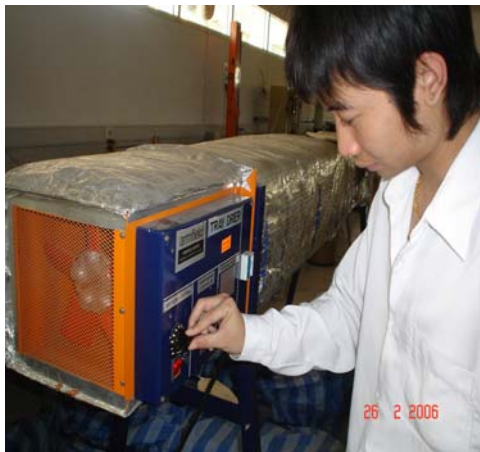
รูปที่ 3.11 การเปลี่ยนความเร็วลมโดยจะใช้ความเร็วลมที่ 0.3, 0.5, 0.7, 0.9 และ 1.0 เมตร/วินาทีตามลำดับ
