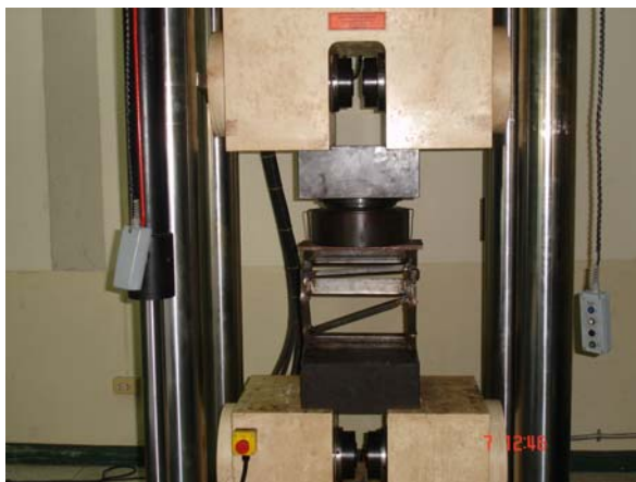
รูปที่ 3.1 แสดงเครื่องทดสอบแบบ Quasi static Compressive & Tensile test Machine
