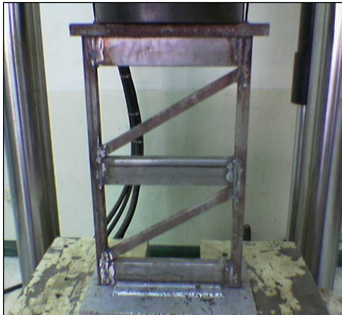
รูปที่ 3.5 การออกแบบตัวจับยึดทดสอบให้รองรับกับชิ้นงานทดสอบ
