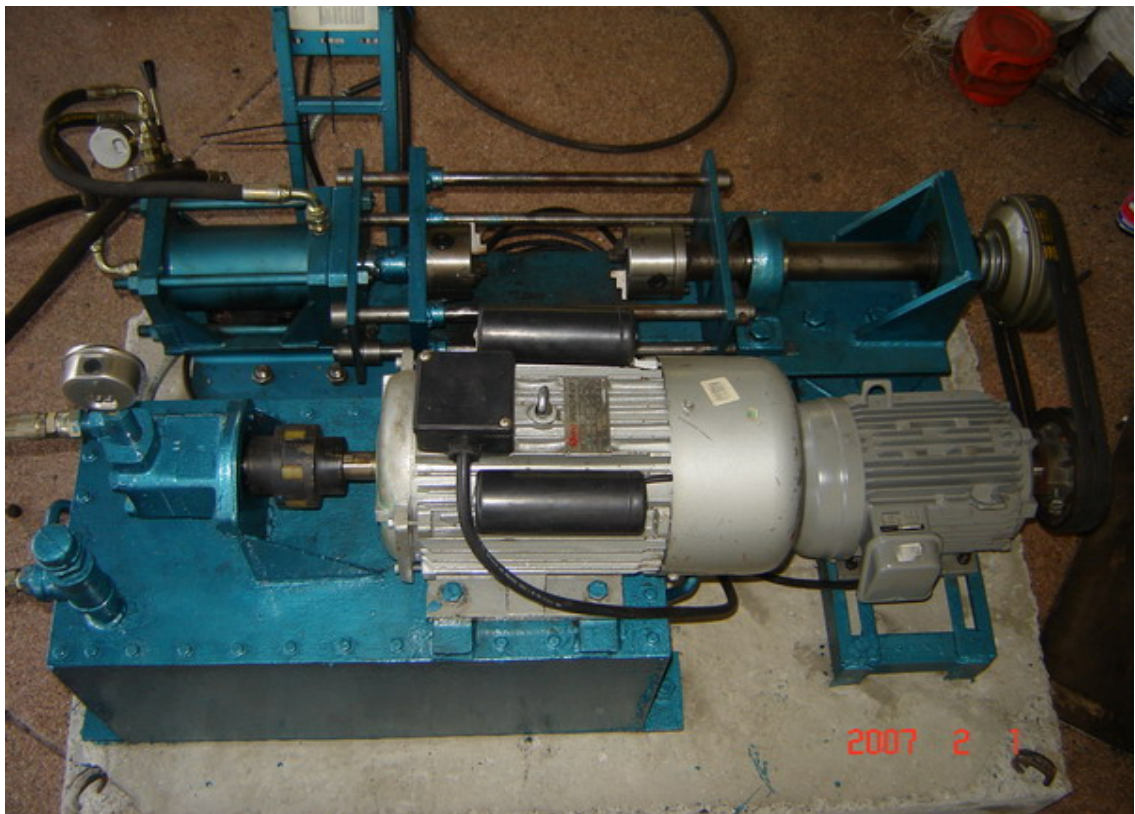
รูปที่ 3.5 แสดงเครื่องเชื่อมด้วยความเสียดทานที่พร้อมจะทดสอบชิ้นงาน
