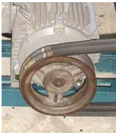
รูปที่ 3.16 แสดงPulley ติดตั้งกับมอเตอร์
