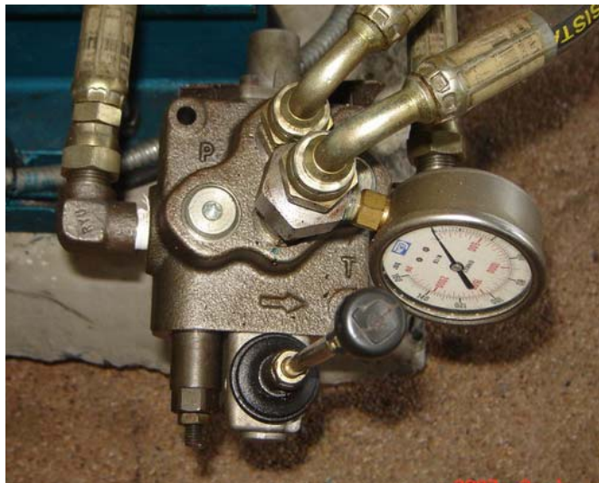
รูปที่ 3.22 แสดงชุดควบคุมทิศทางการเคลื่อนที่ของกระบอกลิขิตไฮดรอลิกส์ ชนิดไป – กลับ
