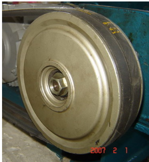
รูปที่ 3.15 แสดงPulley ติดตั้งกับเฟลาขับหมุนชิ้นงาน
