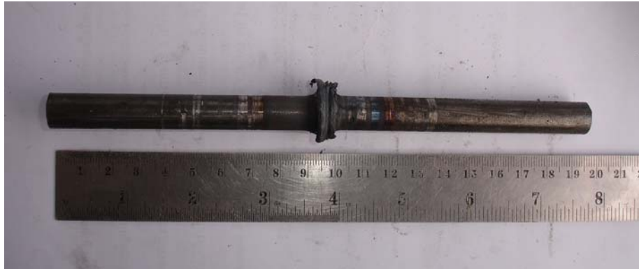
รูปที่ 3.31 แสดงรอยเชื่อมเหล็กเพลขนาด \frac{1}{2} นิ้ว ด้วยเครื่องเชื่อมด้วยความเสียดทาน
