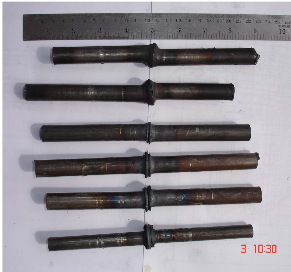
รูปที่ 3.30 แสดงผลตัวอย่างการเชื่อมเหล็กเพลลาด้วยเครื่องเชื่อมด้วยความเสียดทาน
