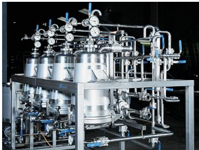
รูปที่ 2.3 เครื่องสกัดแบบการไหลผ่านชนิดหลายขั้นตอน [9]
