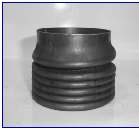
รูปที่ 2.4 แสดงการเสียรูปแบบโมดคอนคอรัตตินา (Concertina mode) ที่ได้จากการทดสอบ
