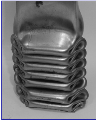
รูปที่ 2.4 แสดงการเสียรูปแบบโมดคอนคอรัตตินา (Concertina mode) ที่ได้จากการทดสอบ
