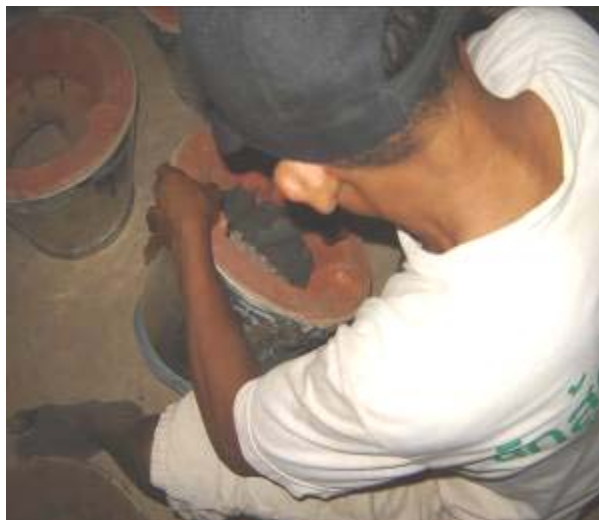
รูปที่ 2.21 การประกอบลินเตา ซึ่งนับเป็นขั้นตอนสุดท้าย
