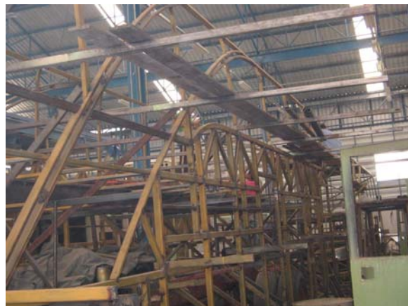
รูปที่ 1.3 แสดงโครงสร้างด้านข้างแบบต่อทแยงมุม (Diagonal side wall)
