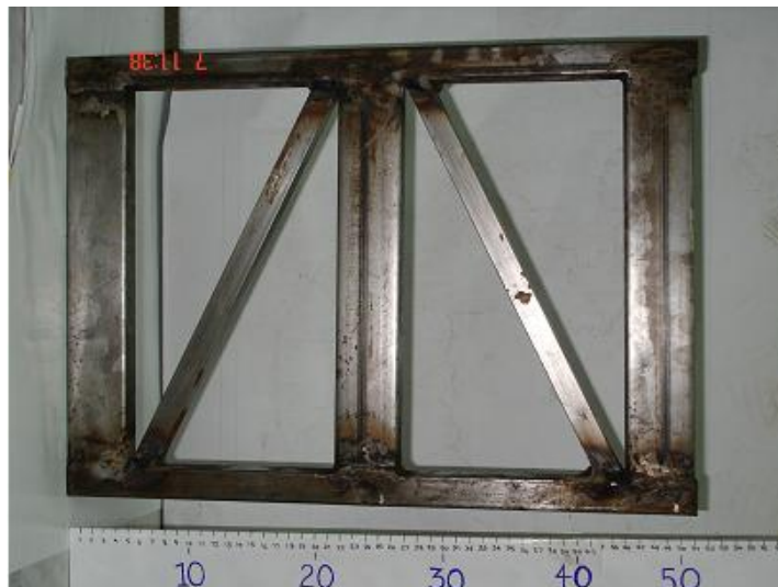
รูปที่ 1.2 แสดงโครงสร้างด้านข้างแบบต่อสลับฟันปลา (Head to tail side wall)
