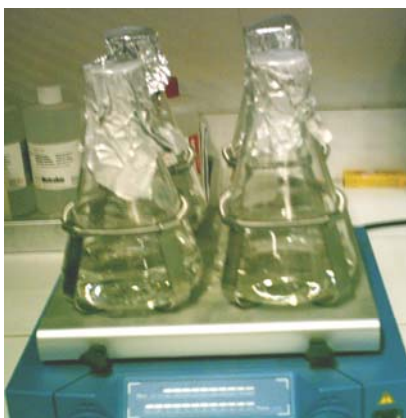
ภาพแสดง การเพาะเลี้ยงโดยบ่มแบบเขย่าที่ความเร็วรอบ 150 rpm อุณหภูมิ 30 °C
