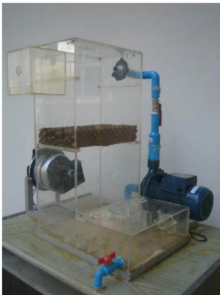
รูป ผ-3 แสดงรูปเครื่องกำจัดวันตะกั่วที่สร้างขึ้น
