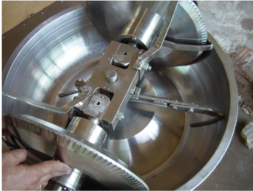
รูปที่ 3.11 รูปด้านบนของเครื่องบดงาแสดงใบกวาดภายในอ่าง
