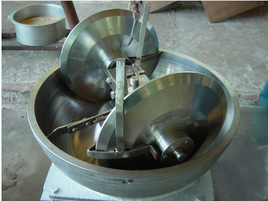
รูปที่ 3.9 อ่างใส่ผลิตภัณฑ์ ล้อบด และใบปาดที่ขอบล้อบดที่ประกอบแล้ว
