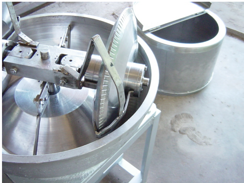
รูปที่ 3.10 รายละเอียดการติดตั้งใบปาดที่ขอบล้อ
