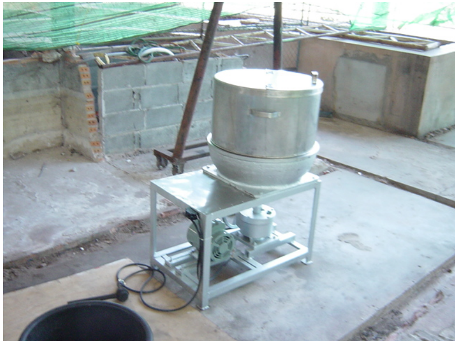
รูปที่ 3.8 เครื่องบดงาที่สร้างเสร็จ
