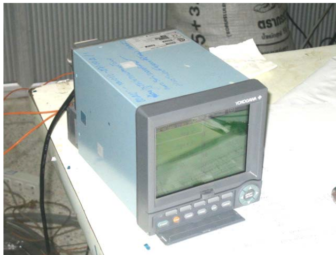
รูปที่ 3.6 เครื่องวัดอุณหภูมิชนิด 12 จุด
