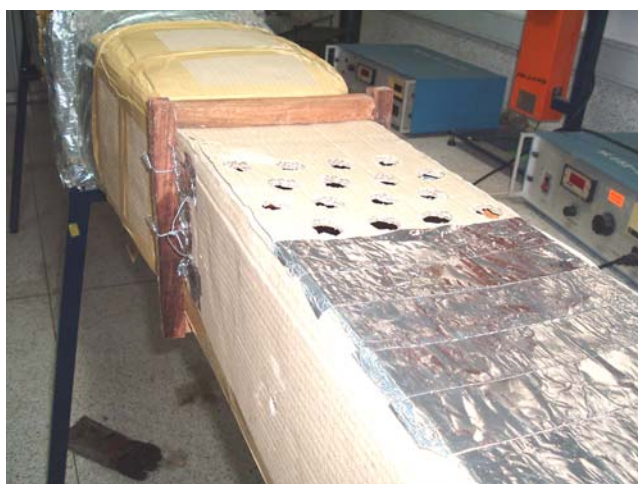
รูปที่ 3.2 ท่อสำหรับบรรจุแห้งสารดูดความชื้น
