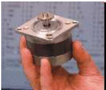
รูปที่ 2.18 สเต็ปมอเตอร์และการทำงาน
